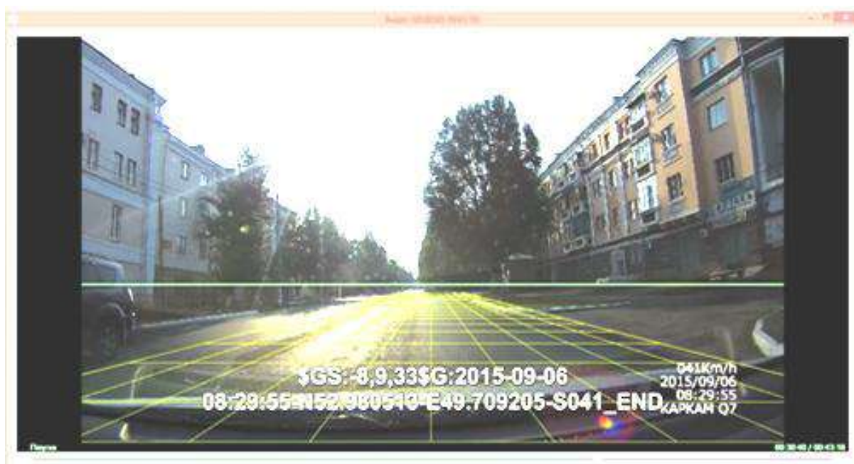
Рисунок 8. Измерение расстояния до объекта в WayMark
